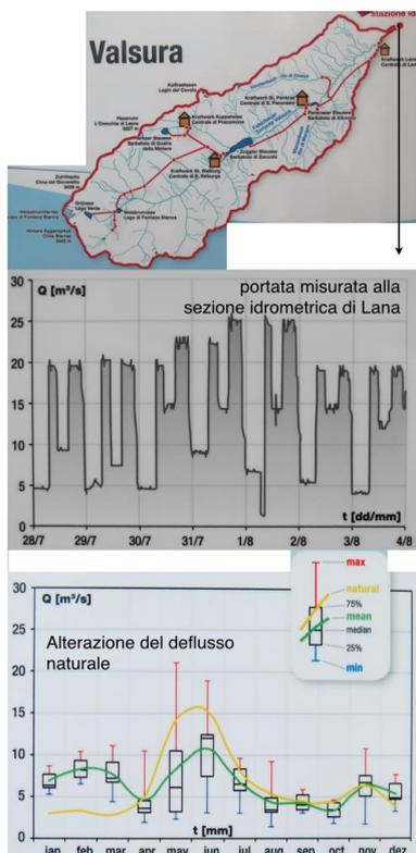
Schema degli impianti di derivazione; (centro) variazione di portata misurata alla stazione idrometrica di Lana; (basso) alterazione del regime idrologico naturale (curva gialla), effettivo (curva verde)
